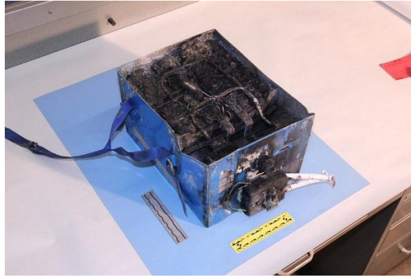
Figura 9 - Bateria de um Boeing 787 após ocorrência de disrupção térmica [16]
